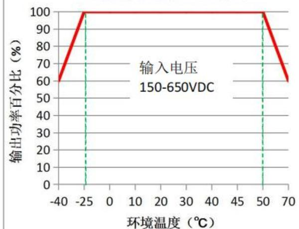
注 1：输入电压为 80~150VDC/650~750VDC，需在输入电压降额曲线图的基础上进行电压降额使用。
